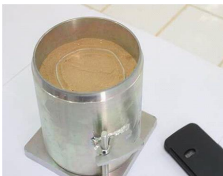
Figure 3. SDD incluant une cellule cylindrique en géotextile.
