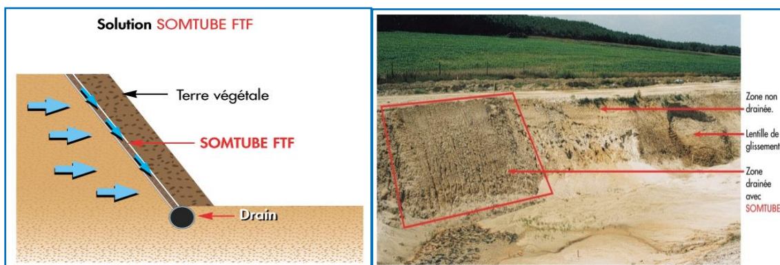
Figure 4. Schéma de principe du géocomposite sur talus.
